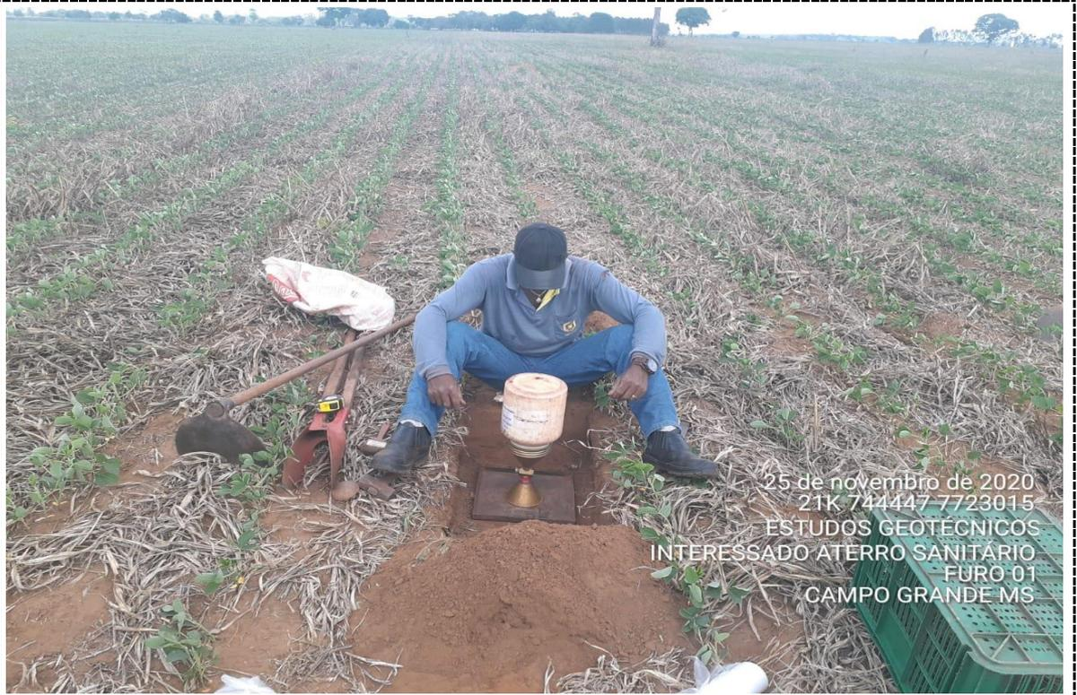
Descrição: Preparação da cava para determinação do coeficiente de infiltração.
