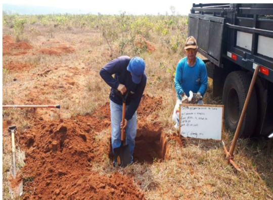
Execução dos furos de sondagens e ensaios de infiltração
