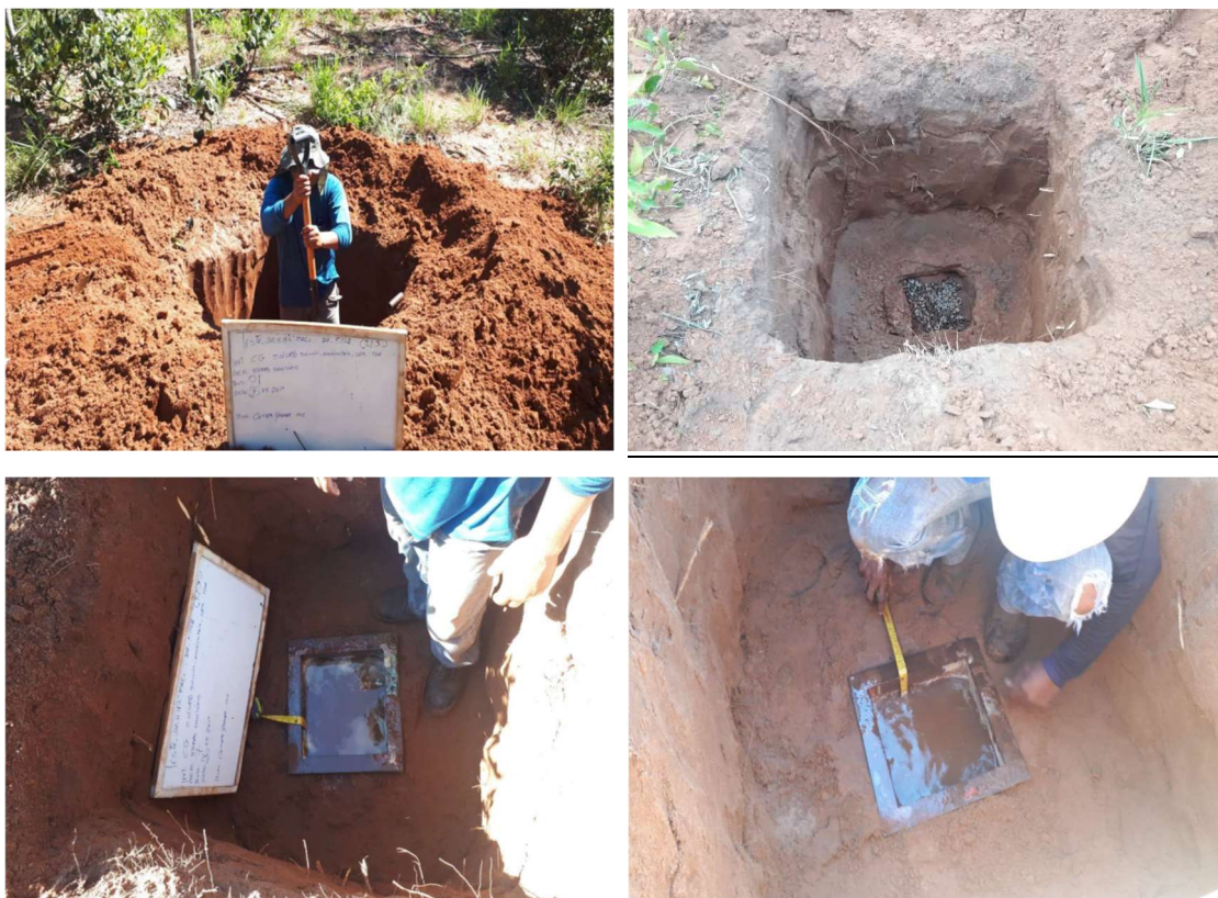
Figura 25 - Execução dos furos de sondagens e ensaios de infiltração de água no solo
