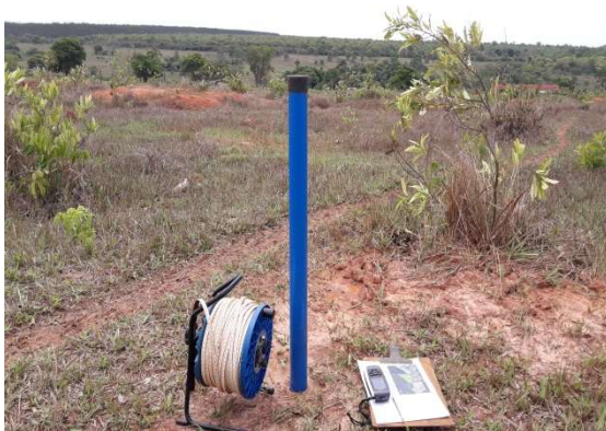
Poços de monitoramentos para obtenção da profundidade do lençol freático e qualidade da água
