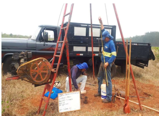
Execução dos furos de sondagens e ensaios de permeabilidade "in situ"
