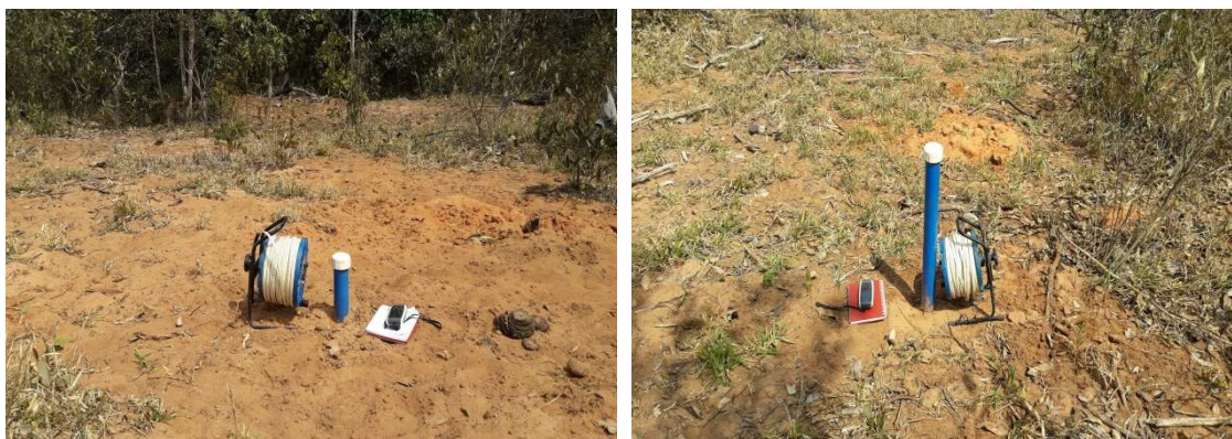
Poços de monitoramentos para obtenção da profundidade do lençol freático e qualidade da água
