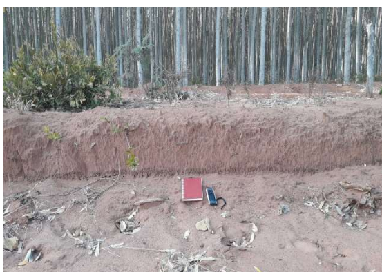
C) Afloramento corte de estrada de acesso da área do Três Barras - Areia quartzosa avermelhada (latossolo arenoso - 20°36'59,6" S - 54°28'27,5"W
