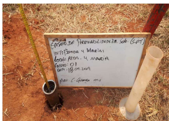
Execução dos furos de sondagens e ensaios de permeabilidade "in situ"
