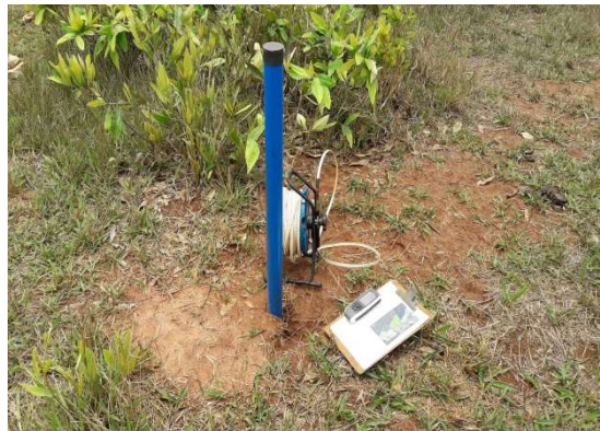
Poços de monitoramentos para obtenção da profundidade do lençol freático e qualidade da água
