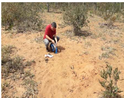
Neossolos quartzarênicos hidromórficos, o lençol freático variou de 2,56 a 2,78 metros de profundidade
