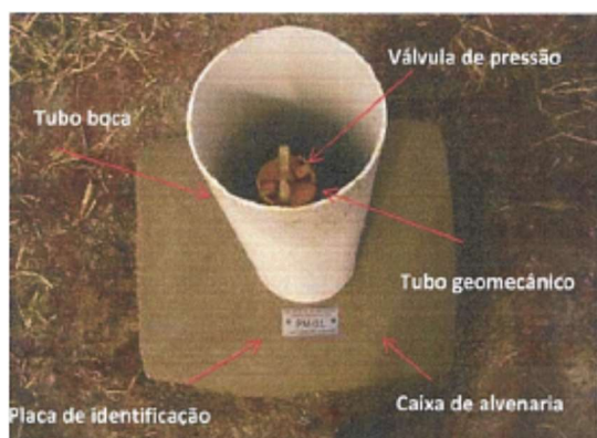
Poços de monitoramentos para obtenção da profundidade do lençol freático e qualidade da água
