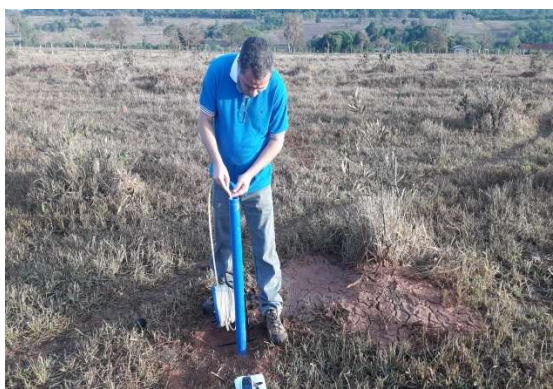
Figura 35 - Poços de monitoramentos para obtenção da profundidade do lençol freático e qualidade da água
