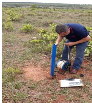
Figura 35 - Poços de monitoramentos para obtenção da profundidade do lençol freático e qualidade da água
